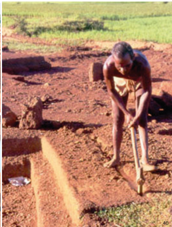
εικ.38: Λατομείο κοπής πλίνθων στη Burkina Faso εικ.39,40: Κοπή πλίνθων από φυσικά σκληρό χώμα στην Orissa της Ινδίας
