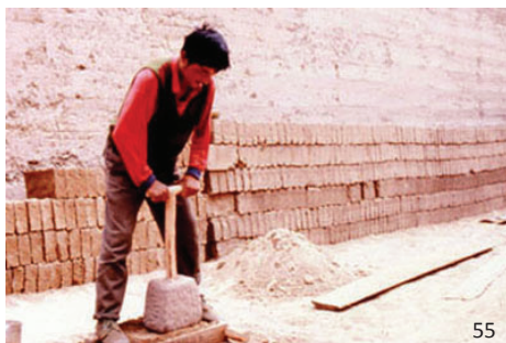
εικ.55: Χειρονακτική παραγωγή συμπιεσμένων ωμόπλινθων εικ.56: Παραγωγή συμπιεσμένων ωμοπλίνθων με τη χρήση χειροκίνητης πρέσας (Paraguay) εικ.57: Μηχάνημα αυτόματης παραγωγής συμπιεσμένων ωμοπλίνθων (Pcific Adobe, ΗΠΑ)
