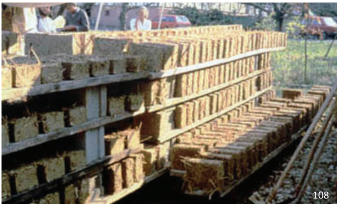
εικ.106: Σκίτσο προκατασκευασμένων δομικών στοιχείων που μπορούν να παραχθούν με straw clay εικ.107: Πλήρωση ξύλινου σκελετού με staw-clay εικ.108: Τούβλα από straw clay εικ.109: Κατασκευή τοίχου από staw clay με τη χρήση μεταλλικού σκελετού και ξυλοτύπου
