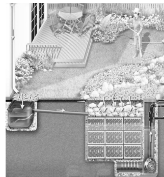
Εικ.9: Σύστημα συλλογής από το δώμα κατοικίας και χρήση για άρδευση κήπου
