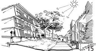
Εικ.15: Πρόσβαση της ηλιακής ακτινοβολίας και σκιασμός στο οικοδομικό συγκρότημα των Foster & Partners
